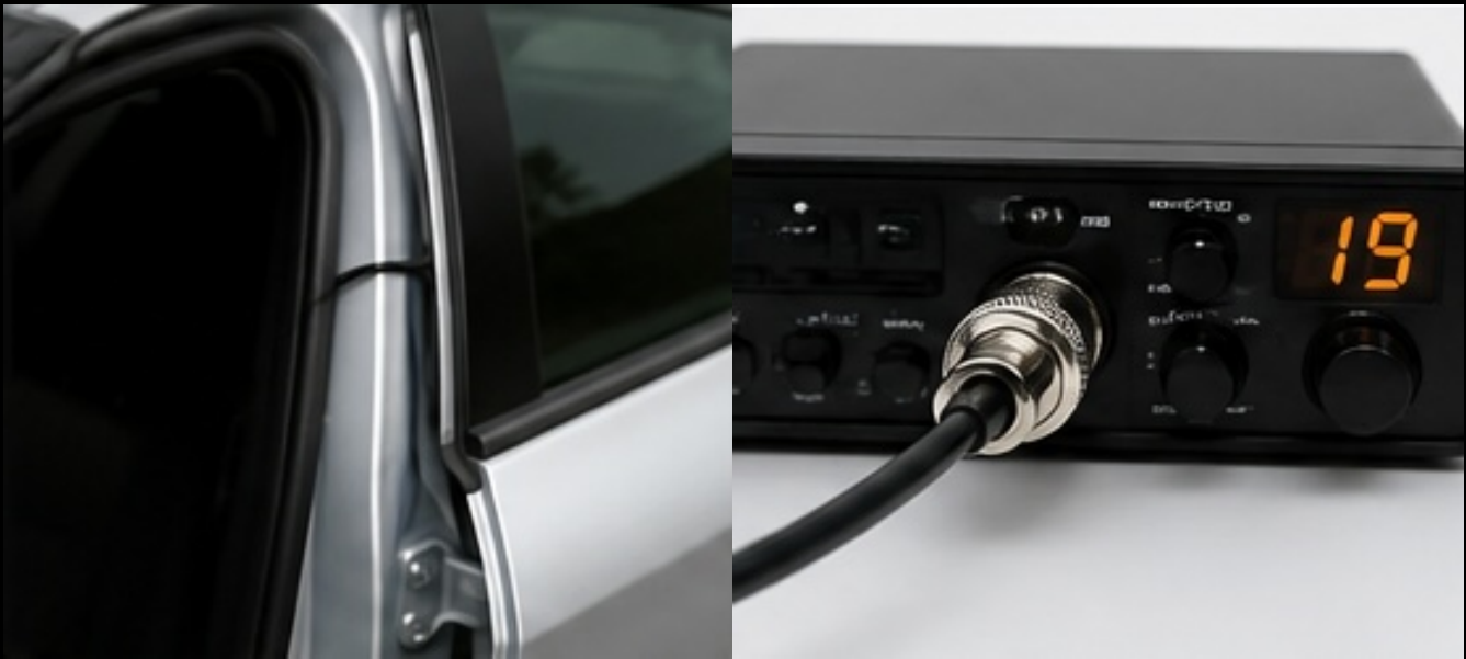
Passage discret du cable par joint de portiere
