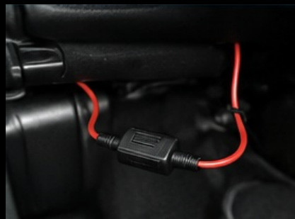
Porte-fusible inline rouge — a placer dans les 30 cm apres la batterie
