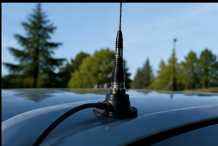
Antenne CB magnétique installée sur toit de véhicule — position idéale pour un plan de masse maximal
